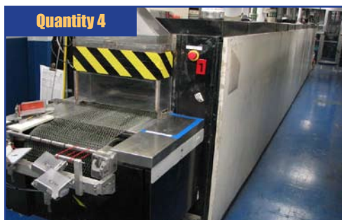
BTU T0161-8-240N48S Diffusion Furnace
