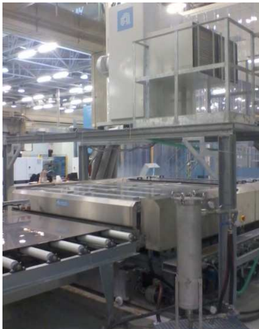
Lavatrici Tipo 3 - Lavaggio vetro dopo processi di molatura Assorbimento corrente 180A (Max 229A)
