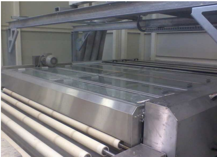
Lavatrici Tipo 1 e 4 - Lavaggio vetro Assorbimento corrente 135A/150A (Max 171,0/186,5A)
