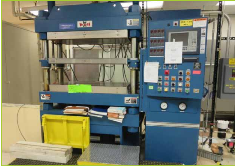
WABASH 2002H-4824-CLPX 200 TON LAMINATION PRESS 200T. 200 TON MAX
