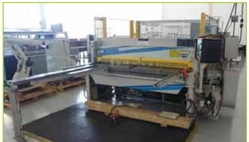
WYSONG 1072 WYSONG PC 100 CNC MECHANICAL SHEAR; 10 GA 6' CAPY
