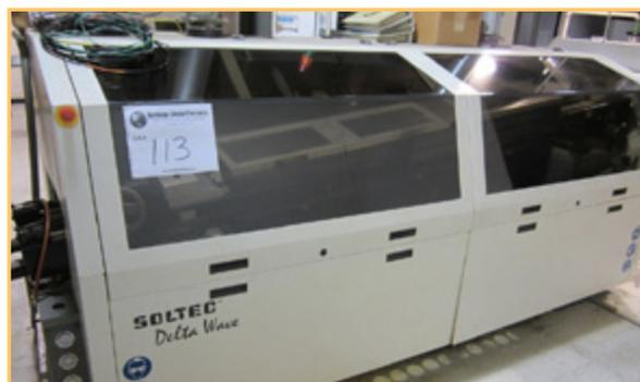
VITRONICS SOLTEC DELTA WAVE 6622 WAVE SOLDERING MACHINE
