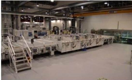
**6:** Vapour Deposition Back Contact
