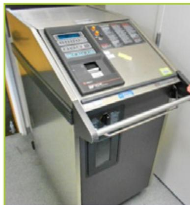
AMSCO VHP-SERIES-1000 VAPORIZED HYDROGEN PEROXIDE BIODECONTAMINATION SYSTEM
