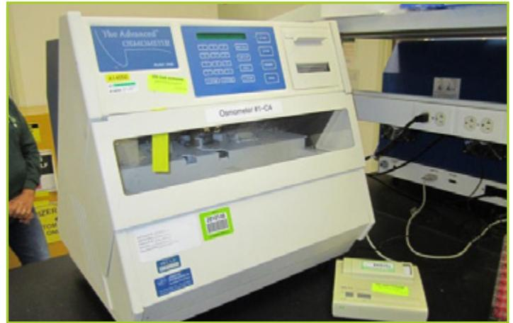
ADVANCED INSTRUMENTS 3900 THE ADVANCED OSMOMETER WITH DPU-414 THERMAL PRINTER
