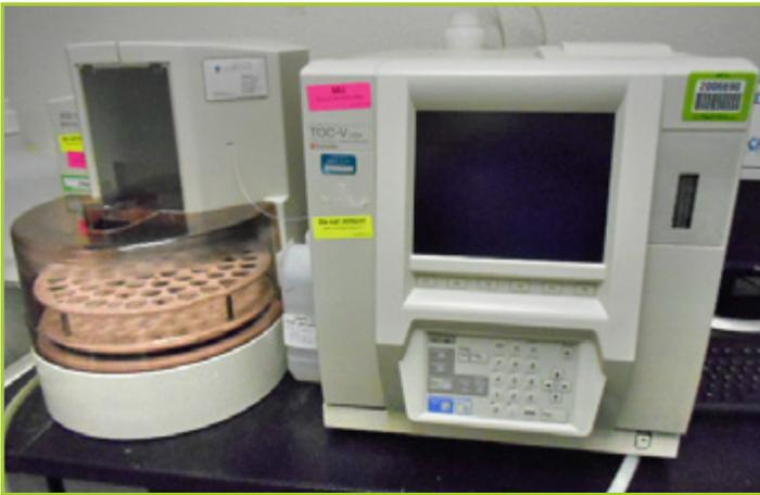
SHIMADZU TOC-V/CSH TOTAL ORGANIC CARBON ANALYZER , WITH MODEL-AS1-V AUTOSAMPLER
