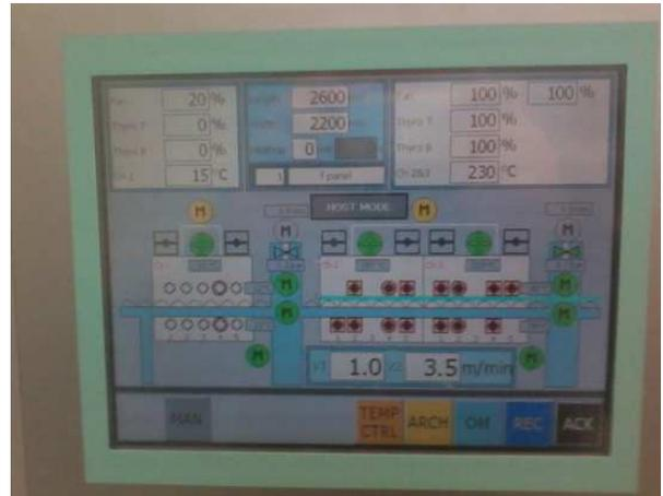
Visione della Stazione di Controllo e relativo pannello operatore (Tipo Touch screen) dove è possibile regolare i vari parametri del laminatoio, temperature, velocità di attraversamento e pressioni dei pannelli.
