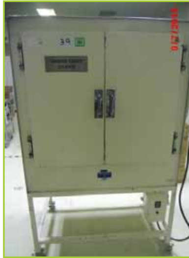
HORNO ELECTRICO DE ACERO AL CARBON CON DOBLE PUERTA DE 70X120X174 CMS. ROBERT SHAW CARBON STEEL ELECTRIC OVEN
