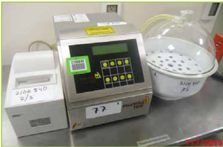
VACUMETRO PARA PRUEBAS DE HERMETICIDAD CON RECIPIENTE LECTOR E IMPRESORA STAR ST500, AÑO 2010. PHARMA TESTER PT-LT-TEST SEAL TESTER
