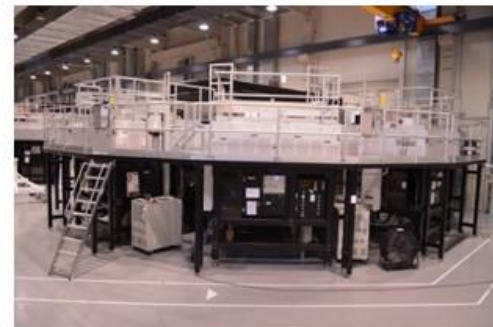
4: Vapour Deposition of a-Si/ \mu -Si
